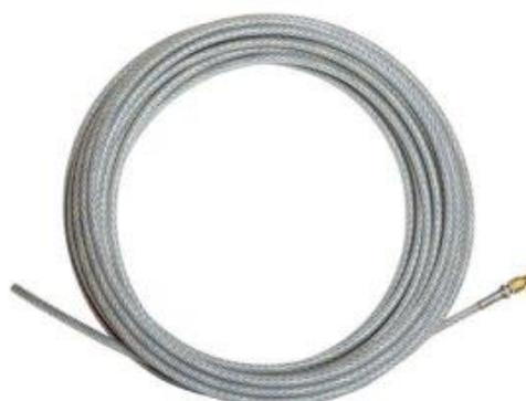
Le principe de fonctionnement du câble Kerie s'apparente à la lance thermique mais contrairement aux tubes métalliques contenant des fils d'alliage, le système se compose d'une gaine en plastique dans laquelle se trouve un câble en acier à forte teneur de carbone duquel l'âme centrale a été retirée afin de permettre le passage de l'oxygène.
