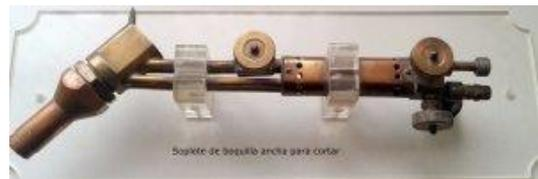
Equipé de quatre vannes, ce chalumeau oxy-propane utilisait le principe de la bulle d'air pour éviter l'extinction de la flamme. Il était selon ses utilisateurs assez difficile à régler mais une fois fait, le chalumeau découpait parfaitement.
