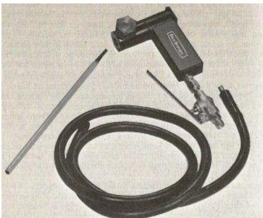
Figure n° 31 : Schéma brevet de la torche Craftsweld (145)
