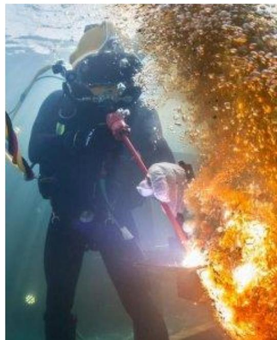
Comme signalé un peu plus haut, les inventeurs de cette nouvelle électrode ultra-thermique se sont probablement inspirés d'un autre procédé de découpage terrestre : La lance thermique. Celle-ci est constituée d'un tube en acier d'environ 3 mètres de long dont le diamètre varie de 13
