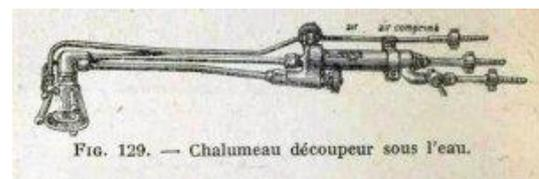
Comme on peut le voir sur le schéma la tête de son chalumeau était équipée d'une cloche dans laquelle arrive deux petits conduits diamétralement opposés par lesquels de l'air comprimé est envoyé et qui a pour but de chasser l'eau de la cloche ainsi que de la zone de métal qui doit être découpée. Autour de sa périphérie la cloche était également équipée de 3 petits guides destinés à garder une distance constante entre la flamme et l'acier.
