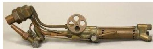
Une vanne quart de tour qui s'ouvre à fond et assure l'arrivée de l'oxygène de chauffe et du gaz combustible dans la buse de mélange et une vanne circulaire pour l'oxygène de coupe.
